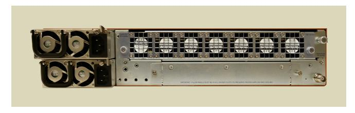
**Figure 4** Power Module (AC Version Shown)
